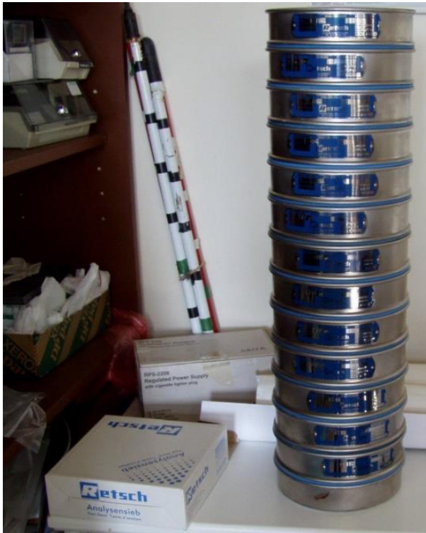
Σχήμα 0-2: Η σειρά των κοσκίνων (τύπου REINTZ) που χρησιμοποιήθηκαν στην κοκκομετρική ανάλυση
