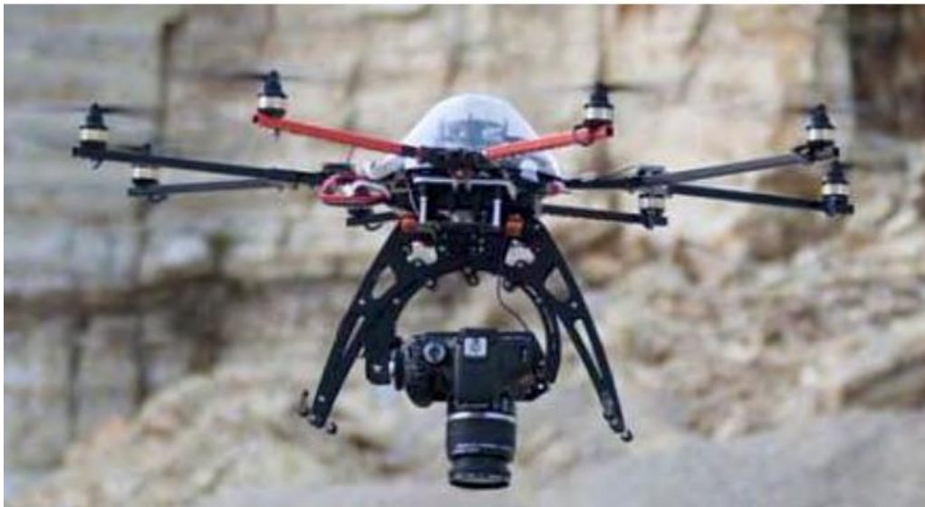
Σχήμα 3-5: Παράδειγμα μη επανδρωμένου αεροσκάφους με 8 έλικες
