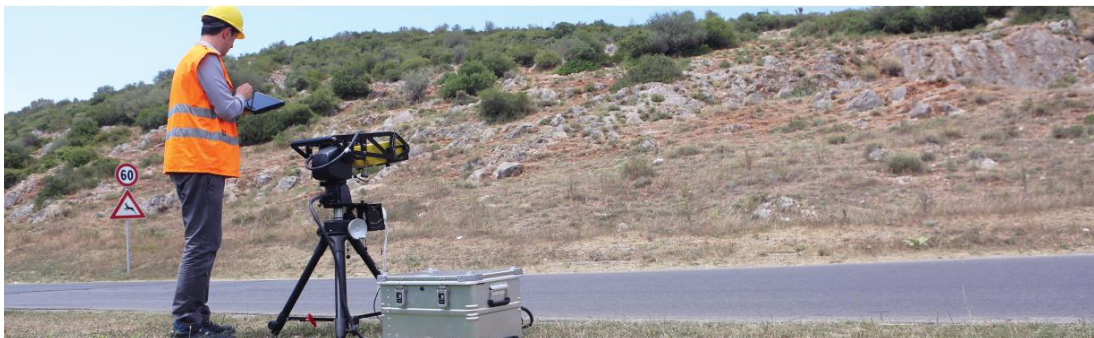
Σχήμα 2-1: Σταθερές (επάνω) και μετακινούμενες (κάτω) συσκευές ραντάρ για την παρακολούθηση κατολισθητικών φαινομένων.
