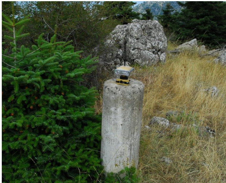
Σχήμα 3-4: Παράδειγμα μη μόνιμου σταθμού αναφοράς (GNSS δέκτης)
