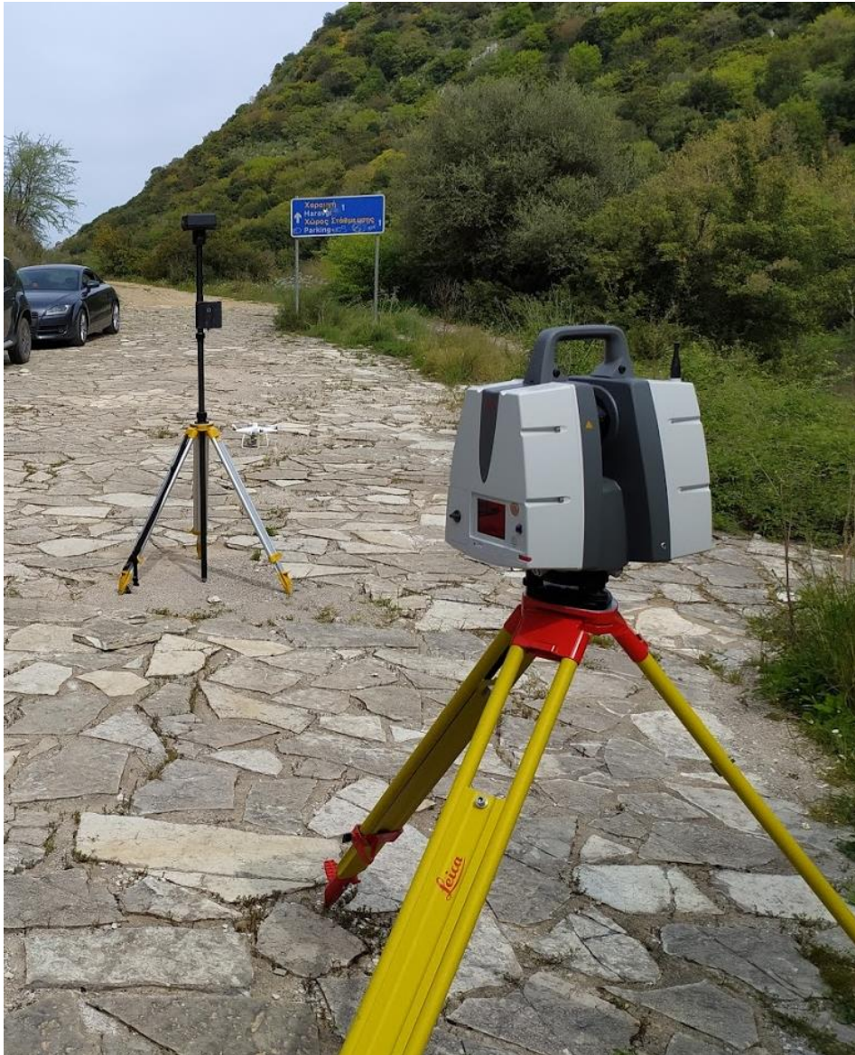
Σχήμα 3-1: Επίγειος σαρωτής αναγλύφου με εμβέλεια μέτρησης μέχρι 1000 μέτρα.
