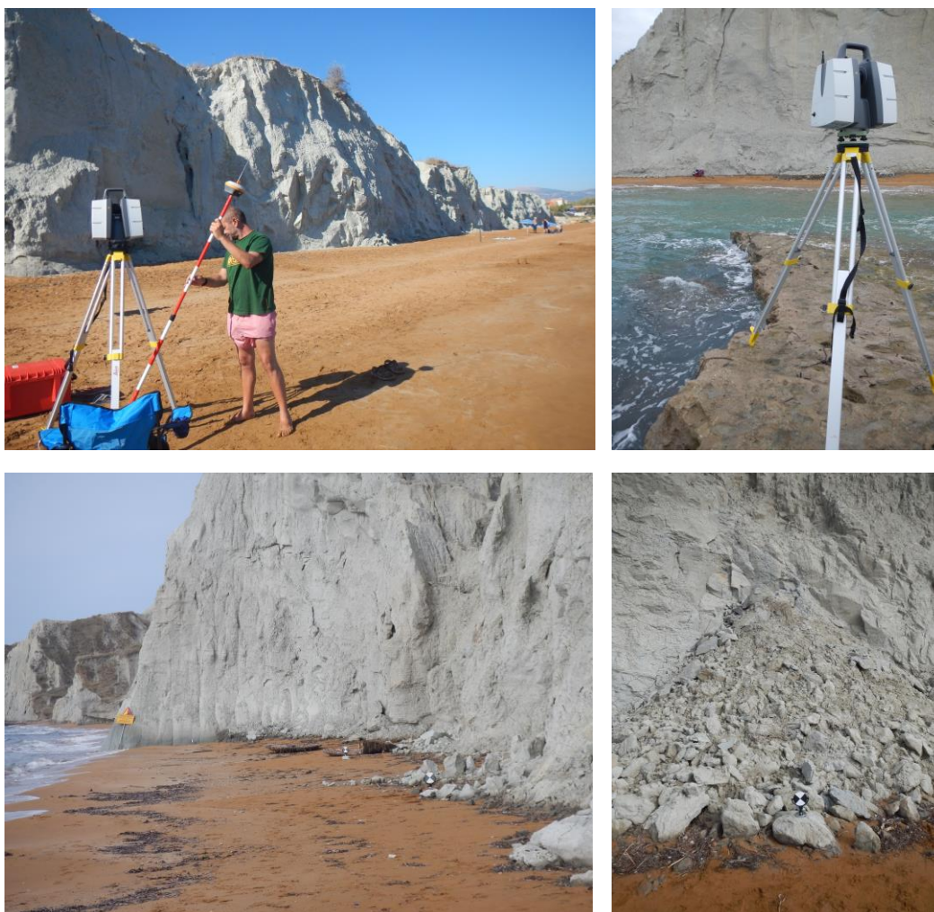
Εικόνα 7.8. Θέσεις στάσεων του σαρωτή και σημεία ελέγχου στην παραλία
