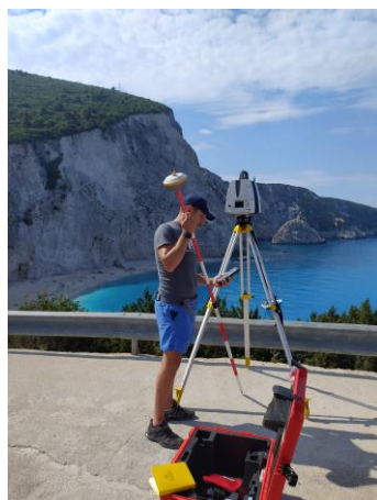
Εικόνα 5.2. Θέσεις σαρωτή και μέτρηση των στοιχείων τους με τον εξοπλισμό υψηλής ακρίβειας.
