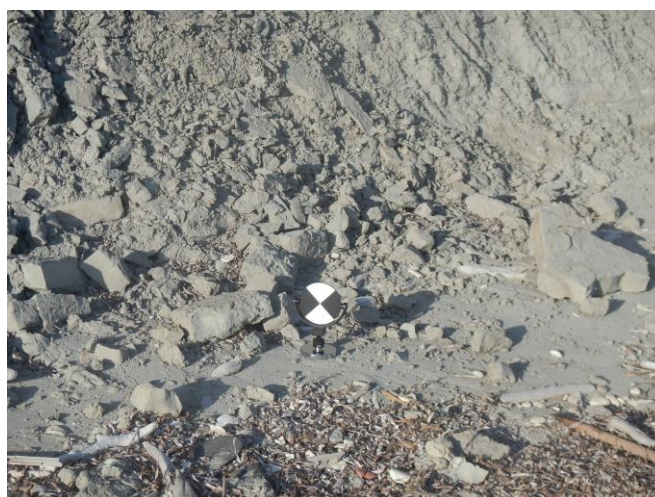
ικόνα 2.2. Θέση στάσης του σαρωτή και σημείο ελέγχου στην παραλία Παλαιοχώρι.
