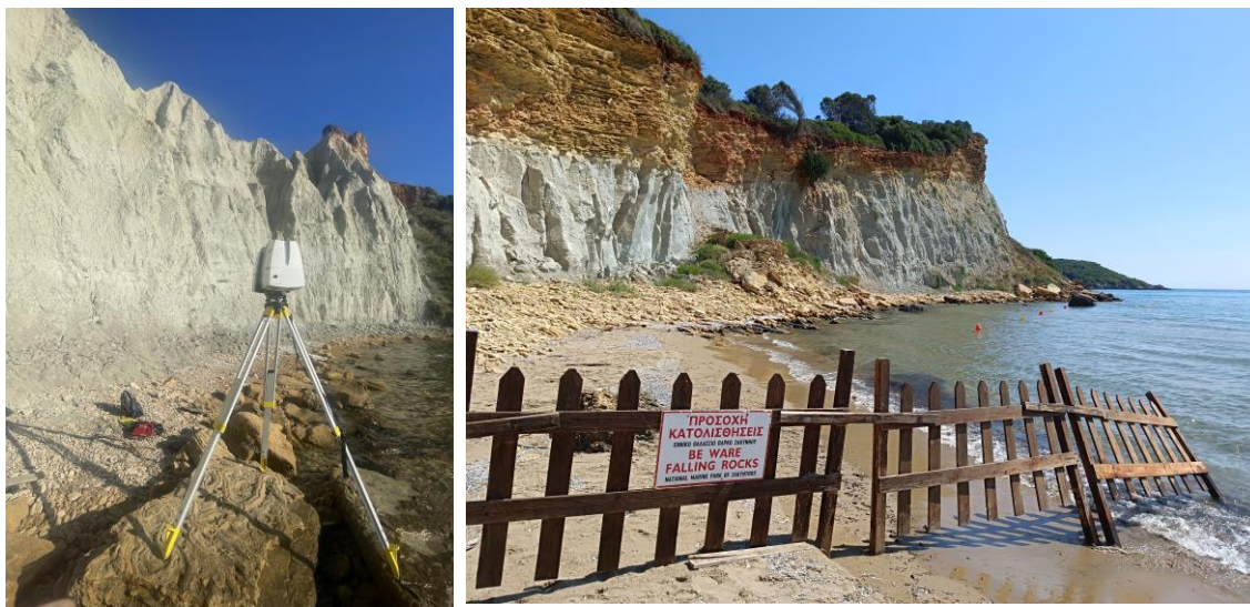
Εικόνα 13.2. Θέσεις σαρωτή και μέτρηση των στοιχείων τους καθώς και των στόχων με τον εξοπλισμό υψηλής ακρίβειας.
