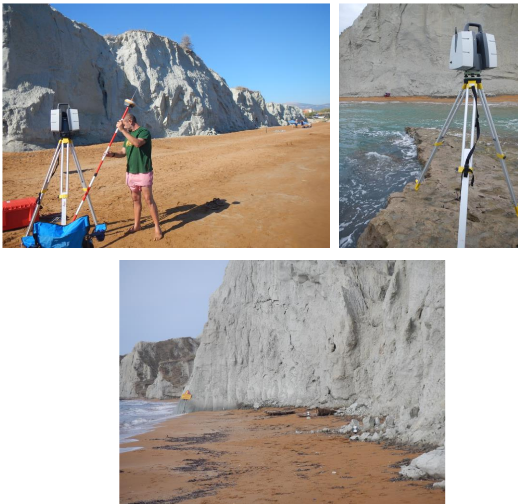
Εικόνα 7.2. Θέσεις στάσεων του σαρωτή και σημεία ελέγχου στην παραλία
