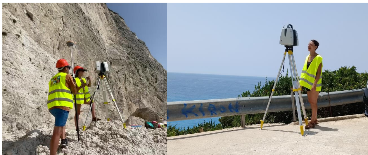
Εικόνα 5.2. Εργασία υπαίθρου με θέση σαρωτή και εξοπλισμός μέτρησης συντεταγμένων υψηλής ακρίβειας.
